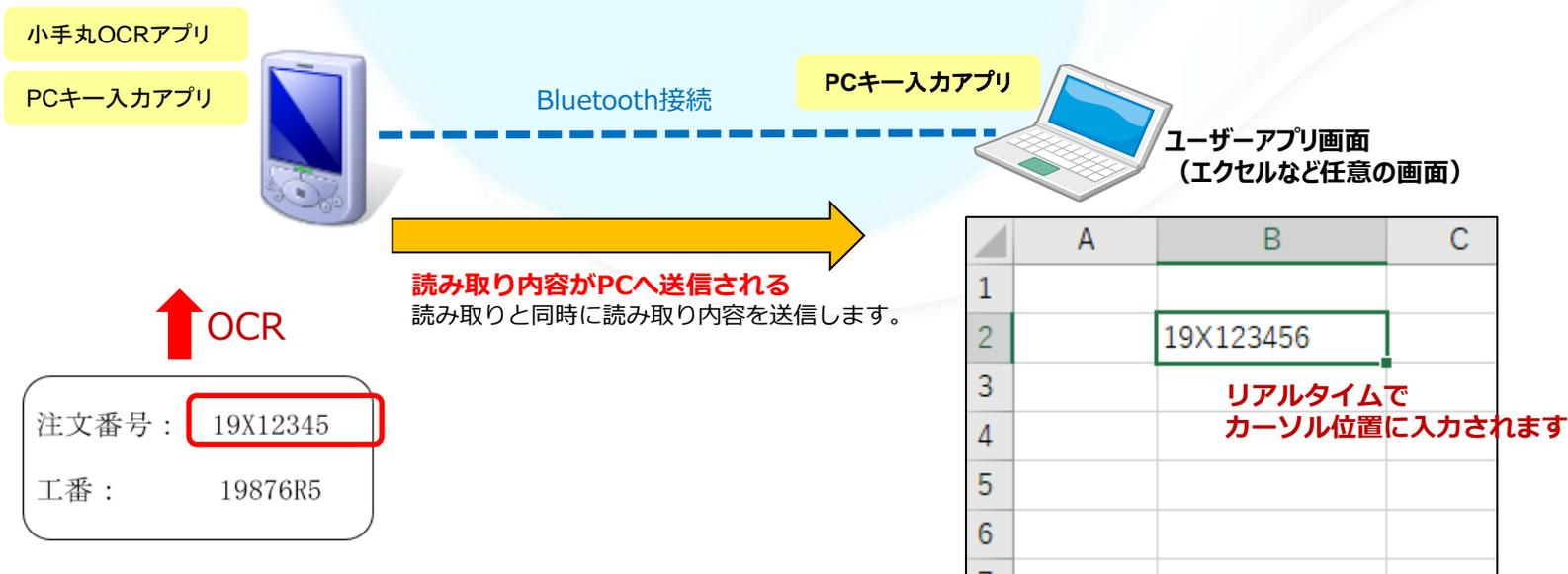
読取内容をモバイル端末とBluetooth接続したPC上にキーボード入力として出力します。
